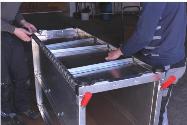
Drehen Sie die Waage um, sodass die Füße nach oben zeigen. Achten Sie auf die Kabel.
