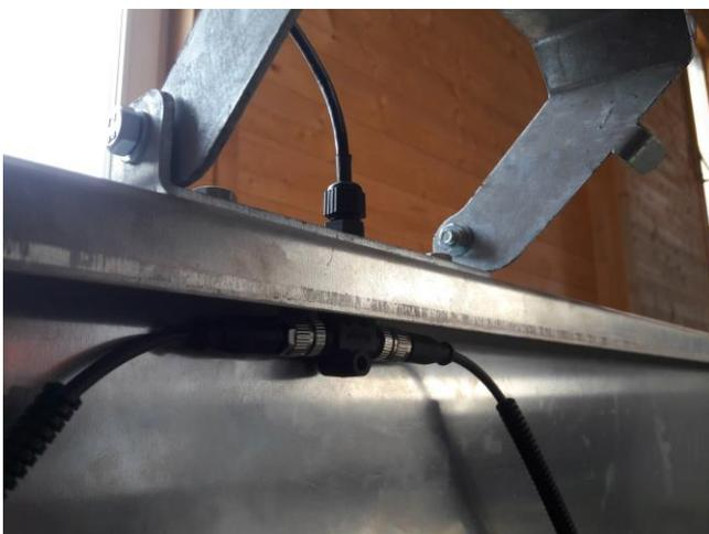
Stecken Sie die beiden Wiegesignalkabel rechts und links an den Verteiler an.
