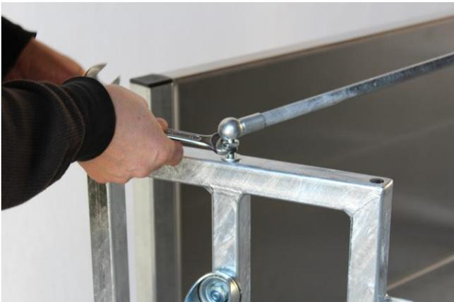
Befestigen Sie die Stange mit einem Kugelgelenk in der mittigen Bohrung an der vorderen Tür.
