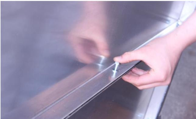
Montieren Sie die jeweils 4 Schrauben pro Seite für die Verschraubung der unteren mit den oberen Seitenteilen.
