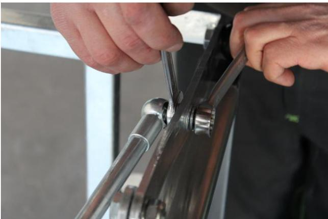
Befestigen Sie die Stange mit dem zweiten Kugelgelenk in der Bohrung am Betätigungshebel.
