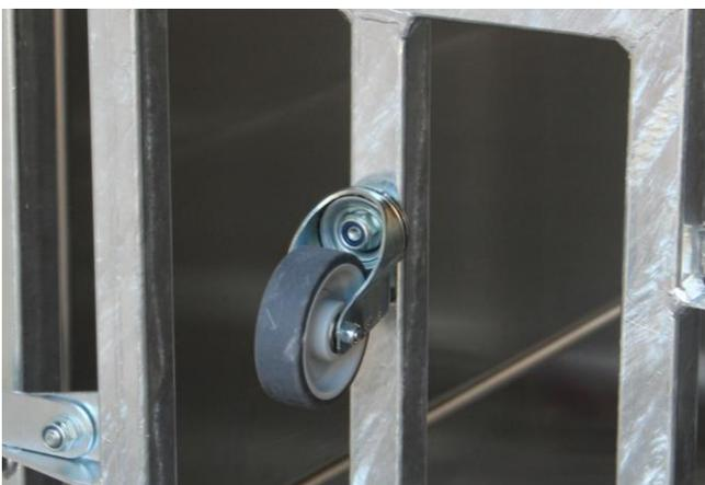
Montieren Sie die Lenkrolle an der vorderen Tür lt. Abbildung.
