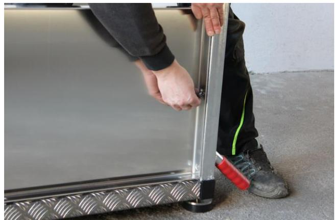
Die oberen beiden Seitenteile sind unterschiedlich. Der linke Seitenteil hat oben 3 Bohrungen, der rechte hat oben 2 Bohrungen. Platzieren Sie die oberen Seitenteile ebenfalls mit der glatten Fläche nach innen, achten Sie dabei auf die Kabel. Befestigen Sie die Teile ebenfalls mit je 2 Schrauben vorne und hinten. Ziehen Sie die Schrauben noch nicht fest.
